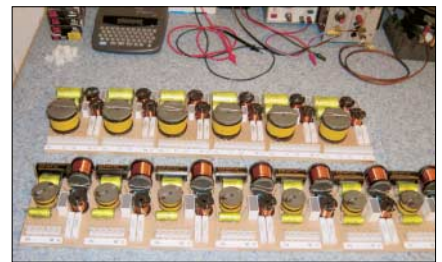
Die Frequenzweichenbauteile werden resonanzfest montiert und fliegend verdrahtet. Dies ist einem Aufbau mittels Platinen vorzuziehen.
