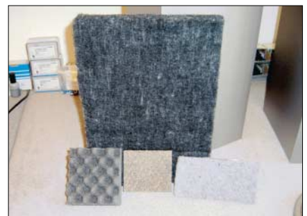
Nicht weniger als 4 verschiedene Dämmmaterialien setzt Rupf gezielt ein, damit die Boxen möglichst resonanzfrei agieren.
