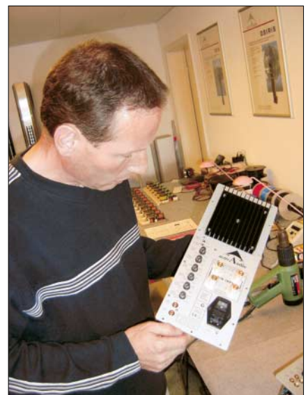
Einige Spitzenmodelle sind teilaktiv aufgebaut. Dabei setzt Rupf für den Tieftonbereich ein Extra-Verstärkermodul ein.
