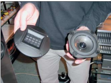
Zwei der High-End-Zutaten für die neue Isostatic-Linie: Aerogel-Mitteltöner von Audax und ein exklusiver isodynamischer Folienstrahler made in USA.
