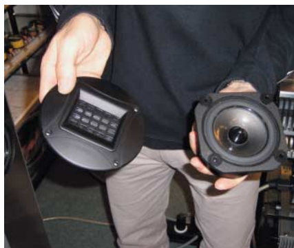
Hochwertige Zutaten: Beim Hochtöner (links) handelt es sich um einen Magnetostaten, der sich durch filigranen Klang auszeichnet. Rechts der Mitteltöner mit Aerogel-Membrane und fest stehendem Phaseplug.
